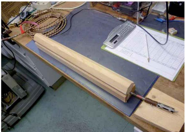
Foto 3: Zur Bestimmung des Schirmmaßes wird der Prüfling auf 0,5 m parallel zur „Störantenne“ eingespannt – diese befindet sich im Unterteil der Spannvorrichtung
