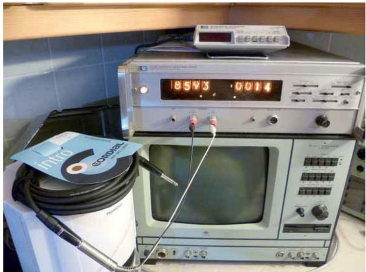
Foto 1: Kapazitätsmessung mit der HP Präzisionsmessbrücke
